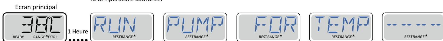
L'écran principal montrera RUN PUMP FOR TEMP si la pompe de filtration n'a pas fonctionné depuis une heure. L'écran principal fonctionnera normalement pendant la filtration.
