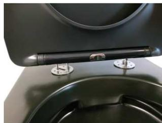
Installez les fixations de l'abattant, pré-vissez-les. Présentez l'abattant afin de définir l'emplacement définitif des fixations. Vissez-les et insérez les caches de fixation.
