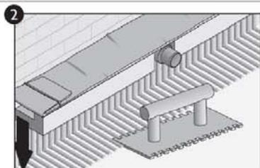
Appliquer de la colle à carrelage (EN 12004 C2) au mur et au sol
