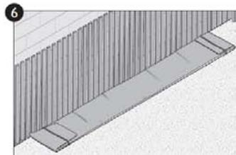
Appliquer de la colle à carrelage (EN 12004 C2) au mur et au sol
