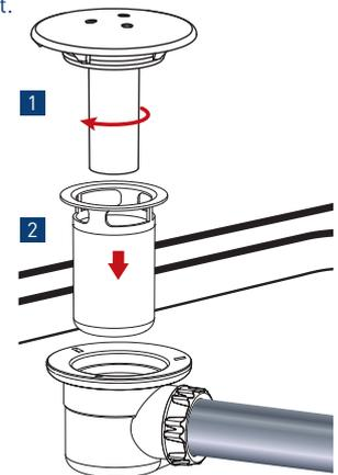
E/ Faire un test en eau pour vérifier l'étanchéité.
