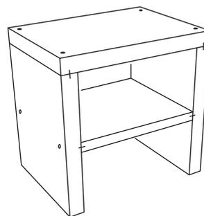
8) Le plan de toilette est maintenant terminé et une fois la colle de montage durcie (env. 24 heures), il pourra être directement carrelé, enduit ou crépi. Pour garantir la solidité, coller le plan de toilette avec le support (paroi et fond) avec la colle BOARD-FIX®. Veuillez tenir compte des conseils ci-dessous.
