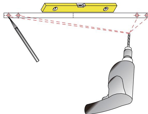
Déterminez la position finale de montage grâce au gabarit et marquez les positions des trous de fixation au crayon.
