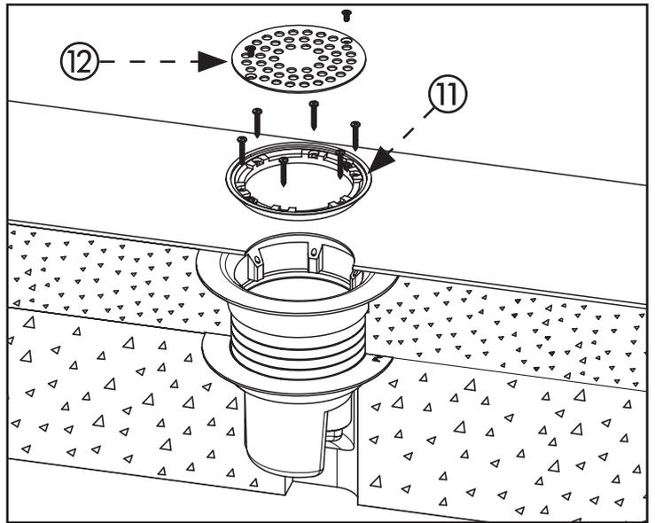
Siphon de sol à hauteur réglable (avec rehausse) pour sol carrelé ou revêtement de sol souple.
