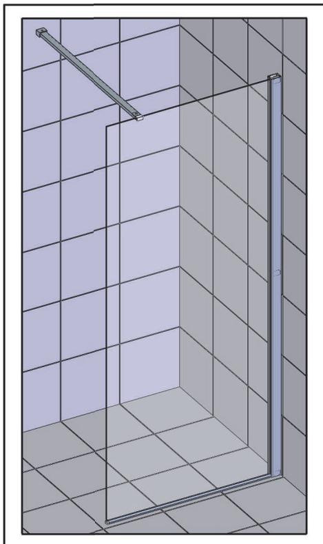
Vous avez la possibilité de réaliser un montage à droite ou un montage à gauche. Notre notice d'installation décrit un montage à droite. si vous voulez réaliser un montage à gauche, il vous suffit d'inverser le montage.
