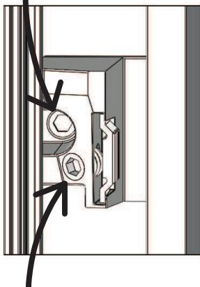
Desserrez la vis de pression pour la mise en place du verre.
