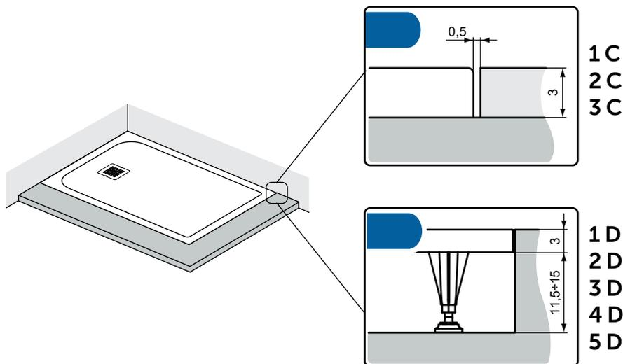
MONTAGGIO A PAVIMENTO - FLOOR ASSEMBLY -
