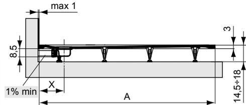
MONTAGGIO A PAVIMENTO - FLOOR ASSEMBLY - MONTAGE AU SOL - MONTAGE AUF DEM BODEN - MONTAJE SOBRE SUELO - MONTAGE OP DE VLOER - ΕΠΙΔΕΛΙΑ ΤΟΠΟΘΕΤΗΣΗ - НАПОЛЬНЫЙ МОНТАЖ - MONTÁŽ NA PODLAHU - MONTÁŽ NA PODLAHE - MONTÁŽ NA TLA - PODNA MONTÁŽA
