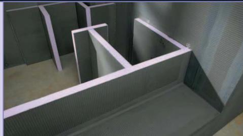
Comme support de construction, des panneaux JACKOBOARD 50 mm sont utilisés. Les supports sont fixés au mur et au sol avec la colle de montage JACKODUR. L'écart est de 40 cm.
