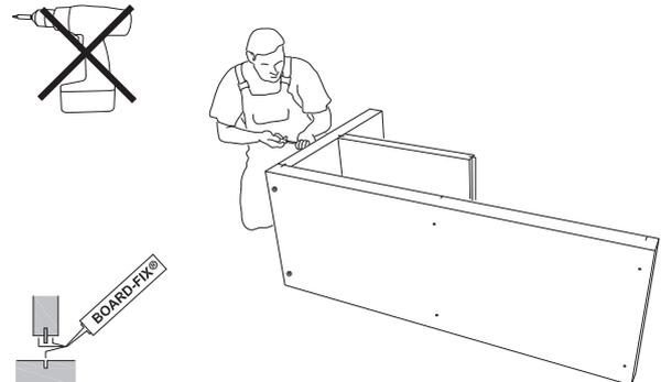
4) Appliquer la colle dans la rainure sur les côtés de la languette (voir illustration) des deux pièces à assembler (paroi latérale et tablette centrale) et visser la tablette centrale.
