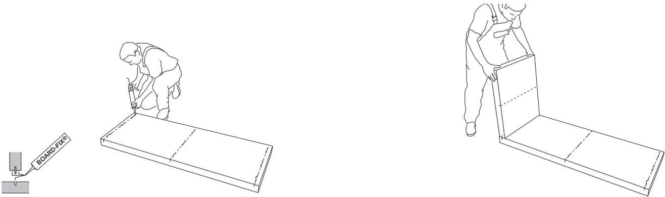
1) Appliquer la colle dans la rainure et sur les côtés de la languette (voir illustration) des deux pièces à assembler (plan de vasque et paroi latérale).
