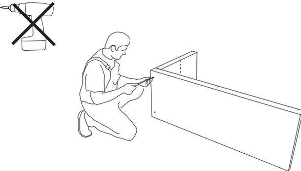
3) Raccorder le plan de vasque avec la paroi latérale par vissage. A cet effet, placer les vis dans les trous prévus en utilisant les rondelles de calage. Visser les vis avec un tournevis à main jusqu'à ce que la tête de la vis soit à fleur avec la surface.
