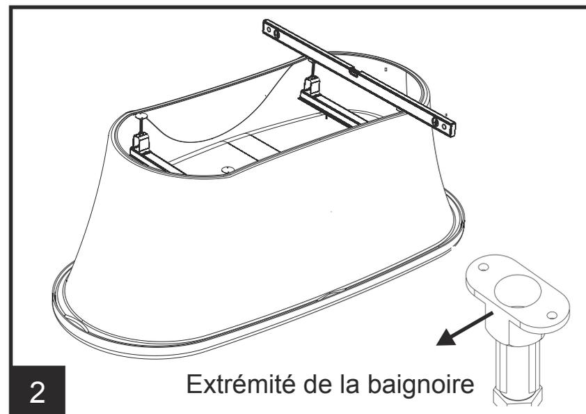
Utiliser un niveau à bulle pour vérifier si les pieds sont alignés afin d'éviter un basculement de la baignoire.
