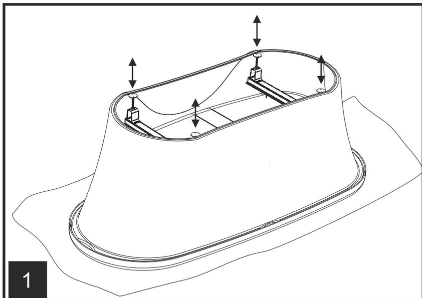
**Remarque :** Avant de retourner la baignoire, placer un support protecteur sur le sol afin d'éviter d'endommager le produit. Monter les pieds de 2 mm au dessus du bord du tablier.
