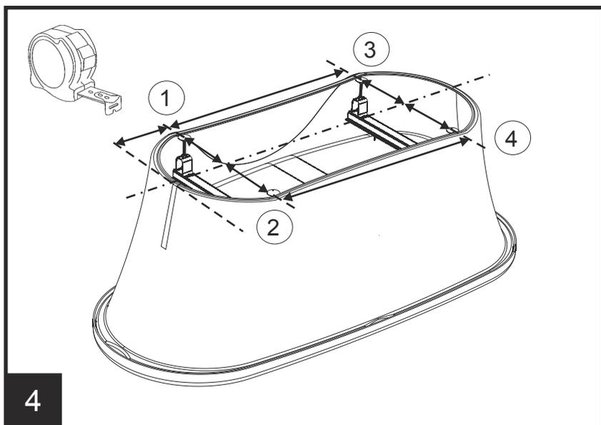
En vous servant d'un niveau à bulle positionné entre les deux lignes centrales au bas du tablier, mesurer la distance au centre de tous les pieds aussi bien que la distance entre les pieds frontaux et postérieurs. Mesurer aussi la distance entre le bas du tablier et le centre du premier jeu de pieds. Mettez un repère sur chaque pied afin de mieux identifier vos côtes plus tard.
