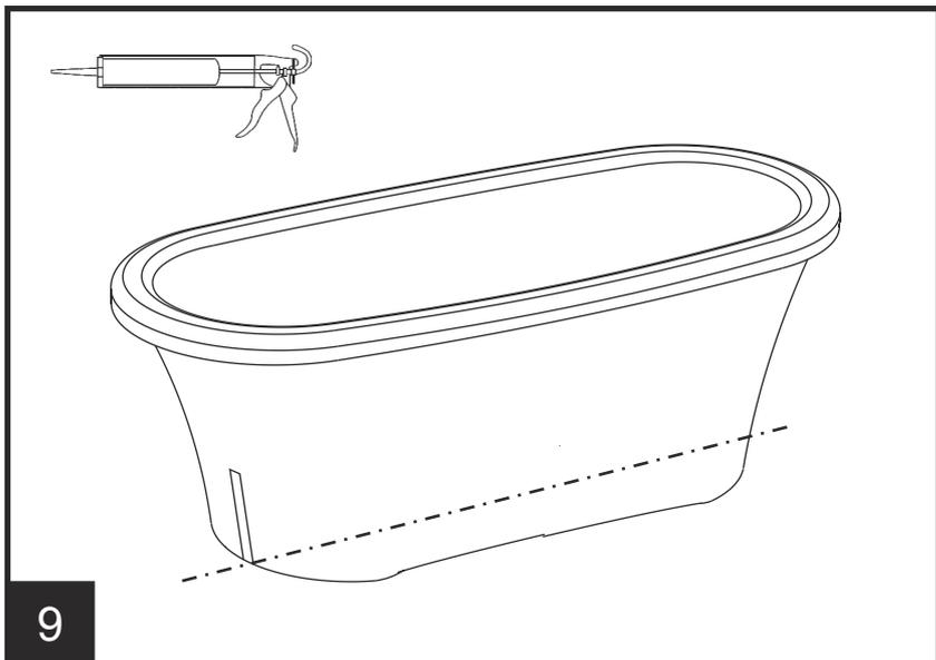
Faire glisser avec précaution la baignoire jusqu'à son emplacement définitif, en alignant l'extrémité du tablier avec la ligne marquant sa position et en veillant à ce que les pieds s'emboîtent dans les 4 clips de maintien.
