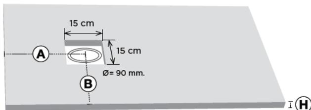
**Receveur de douche avec masse en résine de polyester chargée à 80% d'une base minérale de 3 composants de granulométries différentes. Revêtement de haute résistance fabriqué à base de Gel-Coat ISO NPG.**
