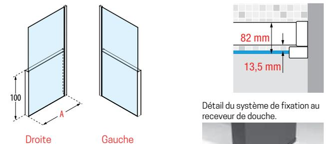
Détail du système de fixation au receveur de douche.
