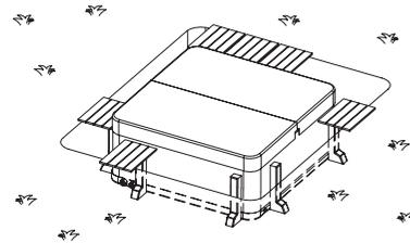
**A** Hauteur dalle béton > 100 mm
