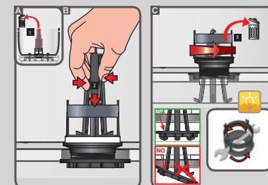
2/ Essuyez le fond du réservoir puis positionnez la base du QUICK FIT dans le réservoir. Clippez l'écrou existant sur la base du QUICK FIT grâce à l'outil.
