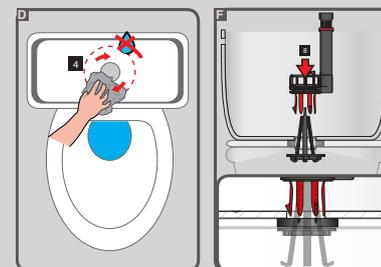
3/ A l'aide d'un chiffon, appuyez fermement sur la base. Le débord du joint vous assure que l'étanchéité est parfaite.
