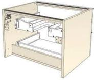
Meuble monté tourillonné collé, suspendu par boîtiers d'accrochage anti-décrochement réglables.
